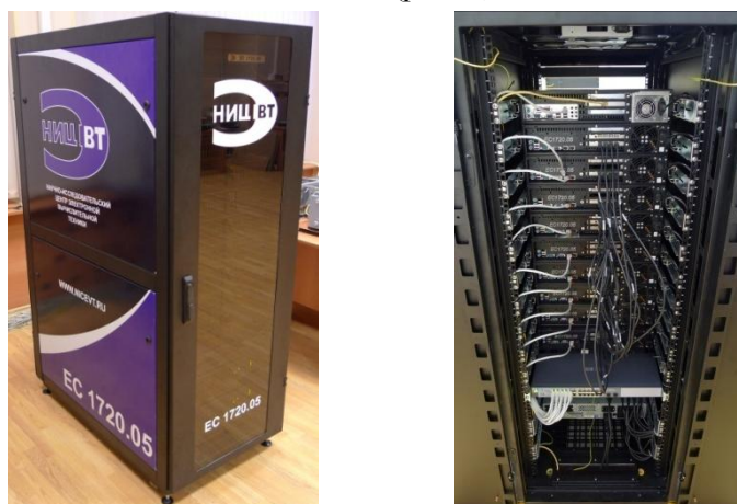
Рисунок 3 – МВС EC1720.05, созданная в ОАО «НИЦЭВТ» из коммерчески доступных компонентов с использованием макетных образцов маршрутизаторов высокоскоростной межзвон-
